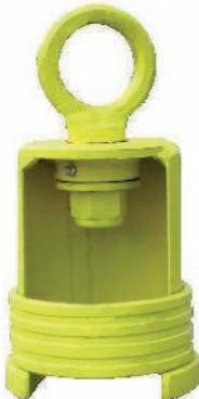
**ELEVATORE A CAMPANA IN ACCIAIO**, adatto solo ai tubi con bicchiere (filettati o meno). Sollevando l'anello, l'elevatore si incastra sotto il bicchiere.
