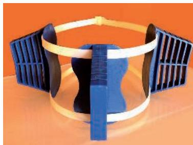
**CENTRATORE IN PLASTICA** per tenere la colonna in posizione centrale durante la fase di calata. È composto da fascette di fissaggio con alette per renderlo adattabile a diversi diametri di perforazione. Le alette, equidistanti tra loro, possono essere tagliate per adattarle alle dimensioni richieste.
