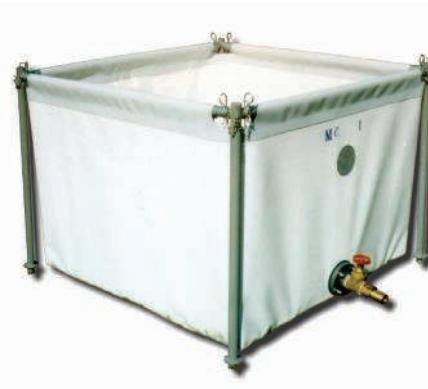
**ITALIANO** **SERBATOIO FLESSIBILE PER IL CONTENIMENTO DI LIQUIDI**, costituito da una sacca in tessuto poliestere extraforte rivestita con plastomeri, sostenuta da un telaio metallico di facile assemblaggio. Capacità da 1m<sup>3</sup> a 60 m<sup>3</sup> (in base alle dimensioni, vedi tabella sotto). Quando non utilizzato il serbatoio può essere ripiegato e ridotto ad un minimo ingombro.
