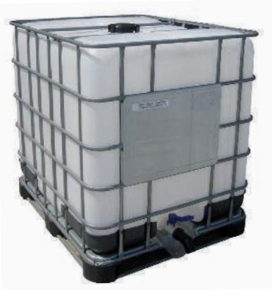
**CISTERNETTA IN HDPE** per il trasporto dei liquidi, con struttura esterna in metallo, dotata di foro di ingresso Ø 135 mm chiuso da coperchio con guarnizione sulla parte superiore e foro di uscita a Ø 50 mm con rubinetto nella parte inferiore. Capacità 1000 lt, dimensioni: altezza 116,30 cm, base 120 x 100 cm.
