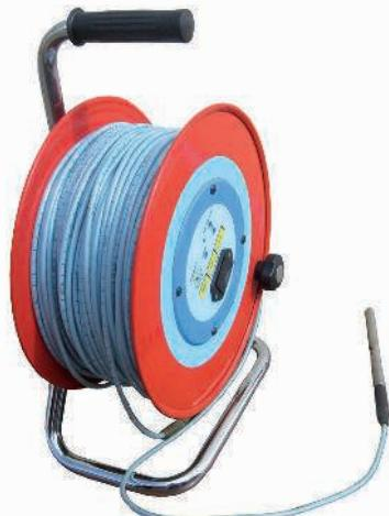
**SONDA DI LIVELLO PORTATILE** per la misurazione della falda in pozzi, piezometri etc. Lo strumento è composto da cavo tondo centimetrato, disponibile in varie lunghezze da 50 a 500 mt, con puntale in acciaio inox 304 Ø 12 mm, completo di rullo avvolgicavo, maniglia per il trasporto e scheda elettronica con avvisatore acustico e luminoso e led di avviso batteria scarica.
