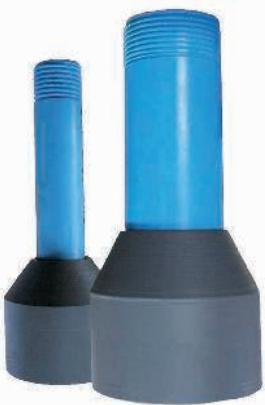
**RIDUZIONI IN PVC** filettate femmina, corredate di tronchetto in PVC filettato maschio/maschio, vengono utilizzate per collegare i tubi in PVC che hanno diametri differenti quando la camera di pompaggio è più grande del pozzo di emungimento.
