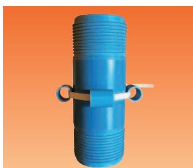
**CENTRATORE IN PLASTICA** per tenere la colonna in posizione centrale durante la fase di calata. È composto da singole unità che si incastrano facilmente tra di loro: una fascetta di fissaggio e nr. 3 piccole sezioni di tubo di vari diametri in base all'occorrenza, equidistanti l'una dall'altra. È una soluzione efficace ed economica.
